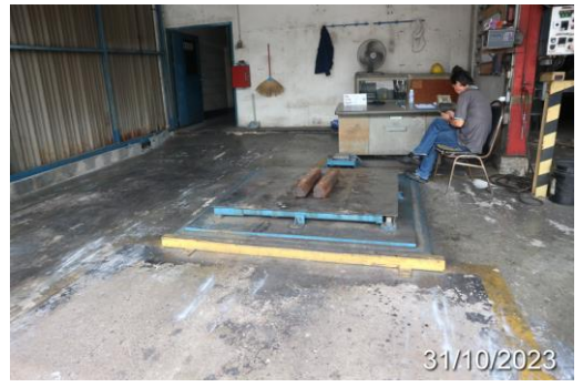
รูปที่ 3-10 ที่ซังน้ำหนักควบคุมรถบรรทุกไม่ให้เกินพิกัด
