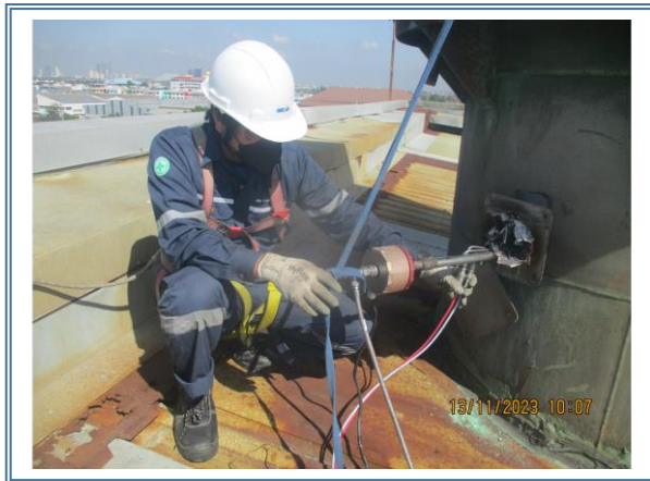
รูปที่ 4-34 แสดงการตรวจวัดปริมาณสารเจือปนในอากาศ ที่ระบายออกจากปล่องระบายเตาหลอม เก็บตัวอย่างในวันที่ 13 พฤศจิกายน 2566
