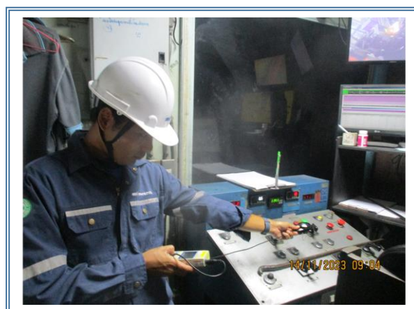
รูปที่ 4-43 แสดงการตรวจวัดความเข้มข้นของแสงสว่าง บริเวณห้องควบคุม Caster Cabin (คุณนาย เทียนกร) ตรวจวัดในวันที่ 14 พฤศจิกายน 2566
