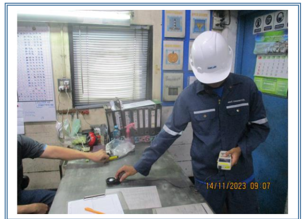
รูปที่ 4-45 แสดงการตรวจวัดความเข้มข้นของแสงสว่าง ห้องควบคุม Furnace โตะทำงานคุณณัฐนันท์ คำสุข ตรวจวัดในวันที่ 14 พฤศจิกายน 2566
